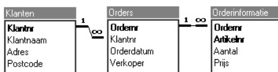
Figuur 1.1.: Voorbeeld van een relationele database met drie tabellen met onderlinge relaties.
